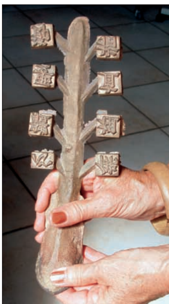
Nachbau koreanischer, im Sandguss-Verfahren gefertigter Bronze-Typen.
