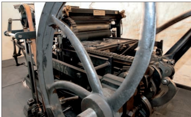
Funktionstüchtige Schnellpresse von Koenig & Bauer von 1867. Foto: DZM.
