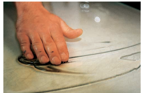
Feuchtung der Gelatineschicht mit einer Glycerin-Wasser-Mischung. Foto: Lichtdruck-Kunst Leipzig e. V.
