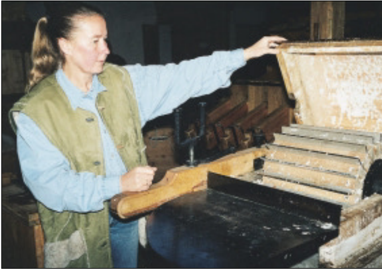
Barbara Seidenschwann zeigt das geöffnete Mahlwerk des Holländers, der die Stampfwerke zu Beginn des 18. Jahrhunderts ablöste und an dessen Stelle heute in modernen Papierfabriken mit starken Motoren angetriebene Refiner-Kegelmühlen getreten sind. Foto: Boris Fuchs
