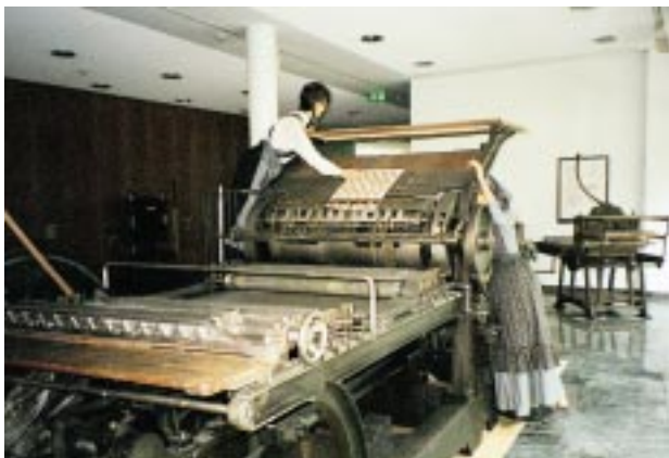
Die Steindruck-Schnellpresse aus der letzten Jahrhundertwende im Foyer des Main-Echo in Aschaffenburg.
