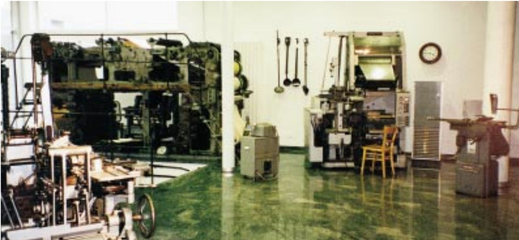
Die Weitläufigkeit des Museums wird in diesem Bild sichtbar. Links ist die Rotation, rechts die Linotype- und im Vordergrund die Monotype-Setzmaschine zu sehen.
